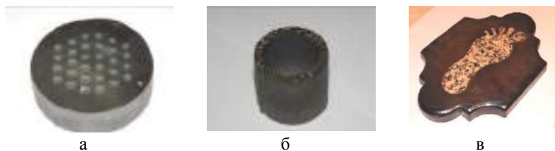
Рисунок 2 – Примеры изделий из литых стеклокристаллически- материалов полученных с применением гидроабразивной резки: а – образец с перфорацией диаметром 3 мм, б – втулка с внешним диаметром 2 см, в – плита с инкрустацией из натурального камня.
