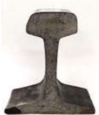
Рисунок 1 – Усталостный излом рельса
