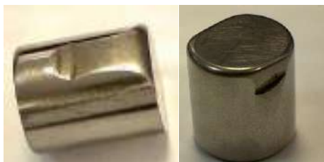
Рисунок 3 - Замины штамповочного происхождения
