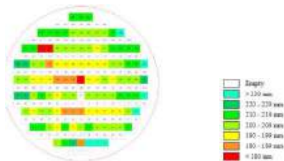
Рисунок 2 – Карта распределения размеров ширины линий по пластине.
