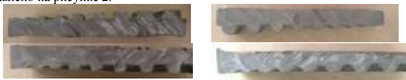
Рисунок 2. Разрез образцов для определения воспроизводимости рельефа.
