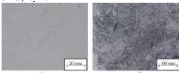
Рисунок 7-Исходная структура стали У8А: а) до травления б) после травления
