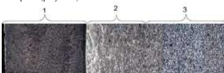
Рисунок 1 – Образец №2 в поперечном сечении: 1 – покрытие, 2 – ЗТВ, 3 – структура основного материала.
