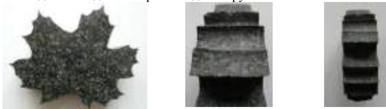
Рисунок 1 – Образец из мрамора «Кленовый лист» и поверхности реза на остроугольных элементах раскроя.
